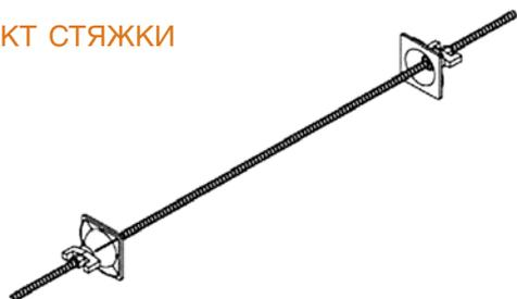
Стяжки предназначены для соединения щитов между собой в проектом положении. Состоит из винта  $d=17$  мм и двух гаек с шарнирной плитой. При демонтаже опалубки стяжки вынимаются.
