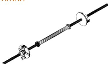
Стяжки предназначены для соединения щитов между собой в проектное положение. Состоит из винта  $d=17$  мм с гайками. При демонтаже опалубки стяжки вынимаются.
